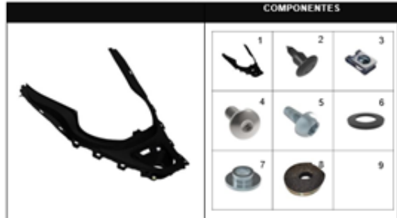
FIGURA 40: CUBIERTA CENTRAL TANQUE
