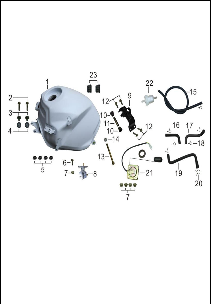
FIGURA N° 22: TANQUE DE COMBUSTIBLE
