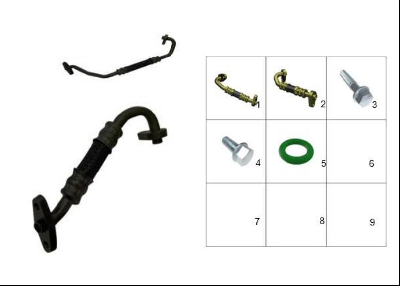
FIGURA 91: TUBO ENTRADA – SALIDA DE ACEITE DE ACEITE
