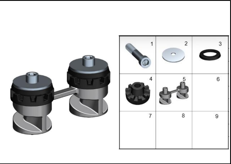
FIGURA 10: SOPORTE TANQUE DE COMBUSTIBLE
