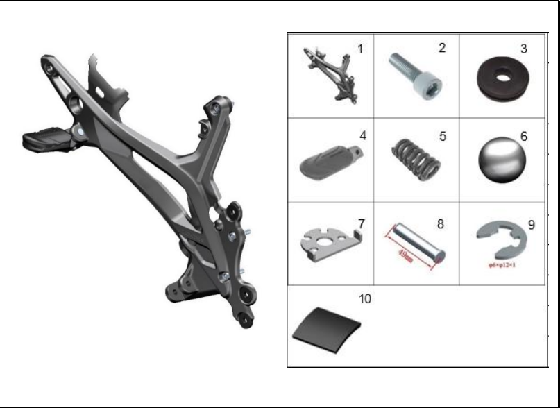
FIGURA 80: SOPORTE REPOSAPIES DERECHO
