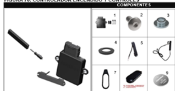
FIGURA 70: CONTROLADOR ENCENDIDO Y CONTROLES
