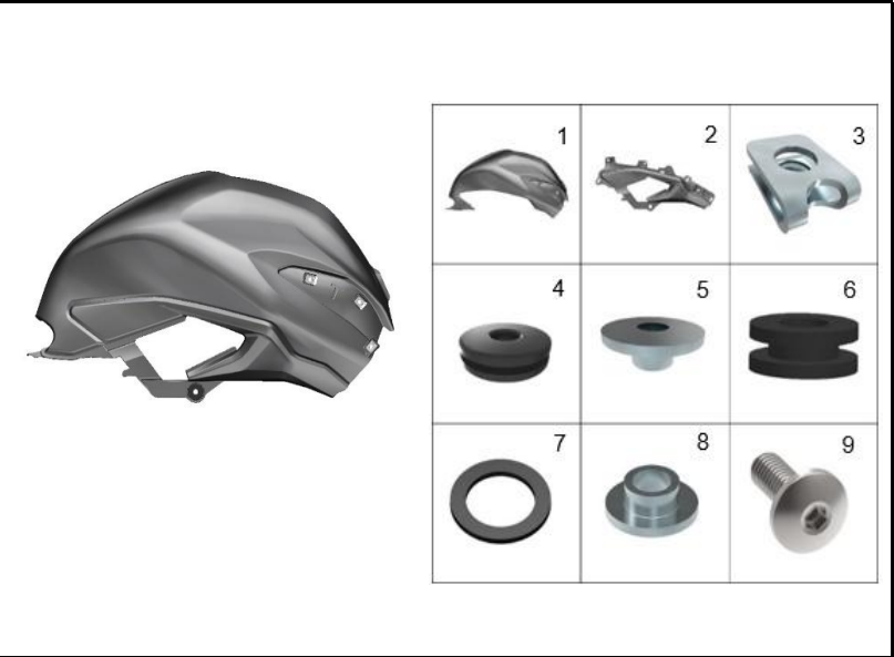
FIGURA 18: CUBIERTA LATERAL DERECHA TANQUE COMBUSTIBLE
