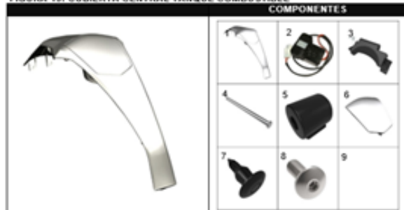
FIGURA 19: CUBIERTA CENTRAL TANQUE COMBUSTIBLE
