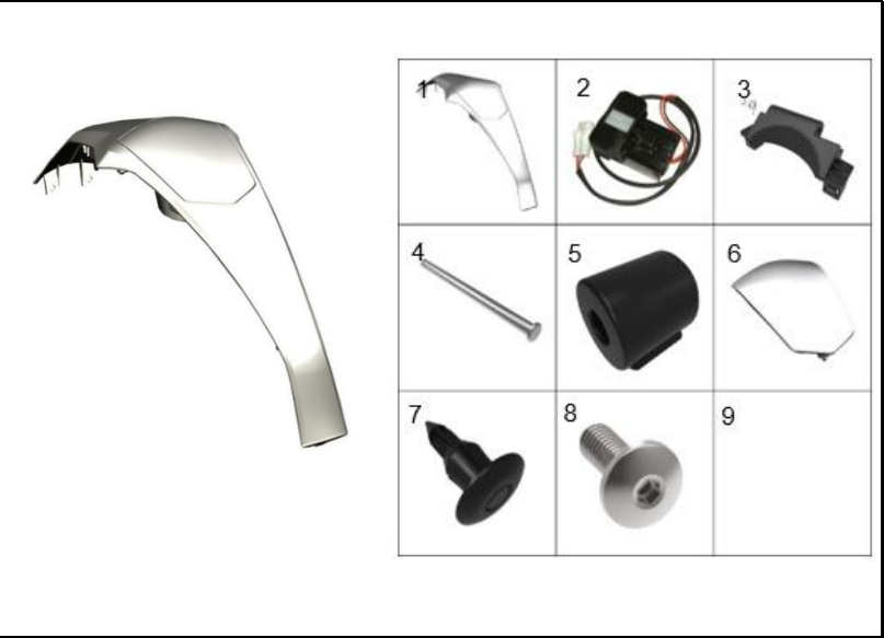
FIGURA 19: CUBIERTA CENTRAL TANQUE COMBUSTIBLE
