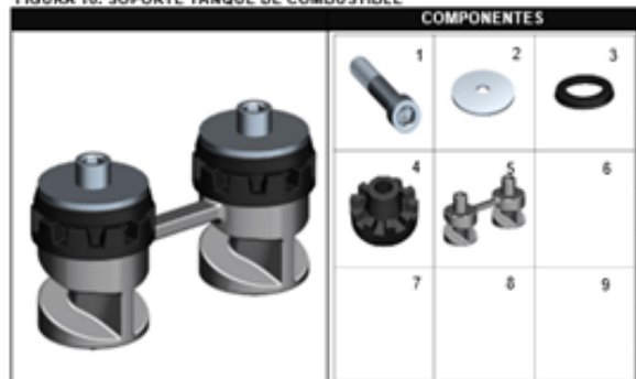
FIGURA 16: SOPORTE TANQUE DE COMBUSTIBLE
