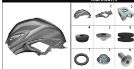
FIGURA 17: CUBIERTA LATERAL IZQUIERDA TANQUE COMBUSTIBLE
