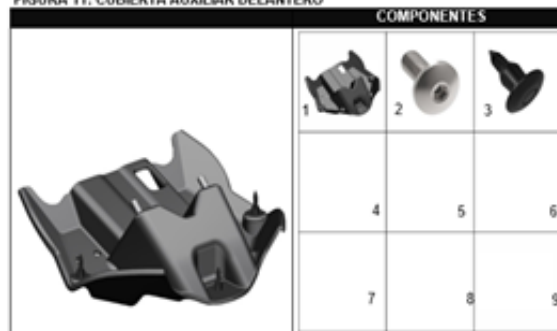
FIGURA 11: CUBIERTA AUXILIAR DELANTERO
