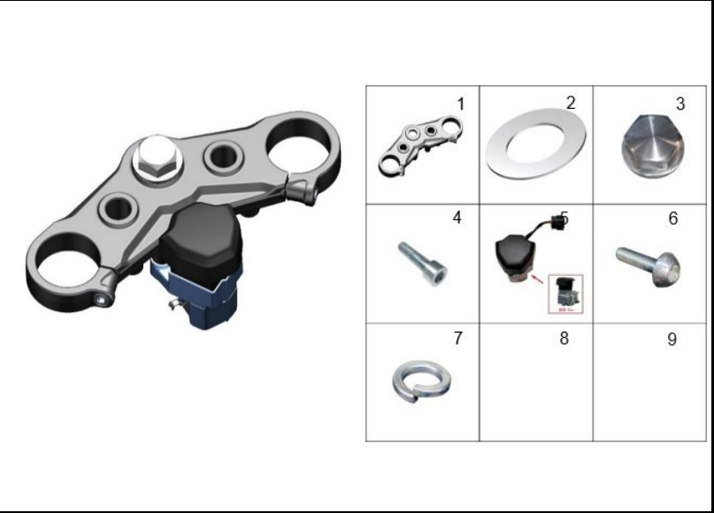
FIGURA 44: SOPORTE TUBOS SUSPENSIÓN DELANTERA
