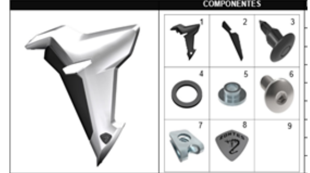
FIGURA 21: CUBIERTA TANQUE IZQUIERDA
