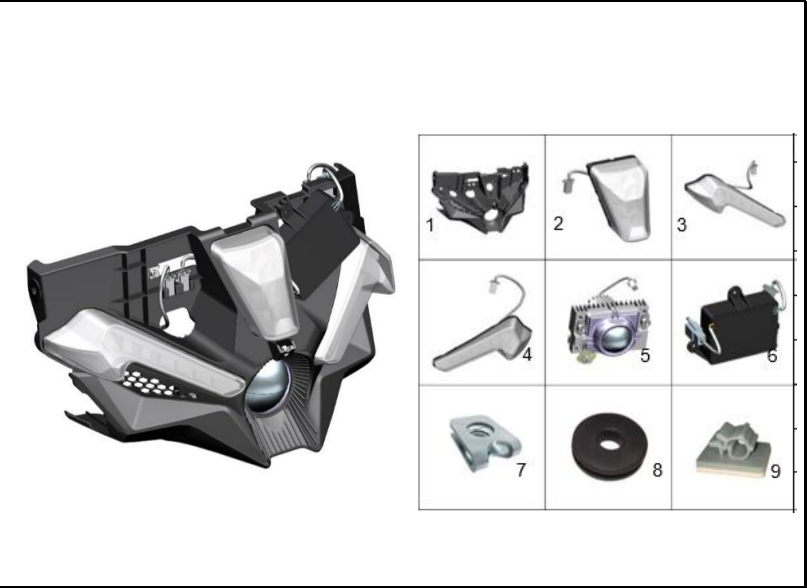
FIGURA 11: CUBIERTA INTERNA FAROLA
