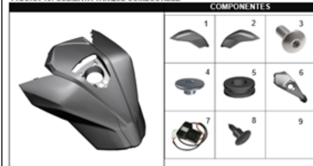
FIGURA 18: CUBIERTA TANQUE COMBUSTIBLE
