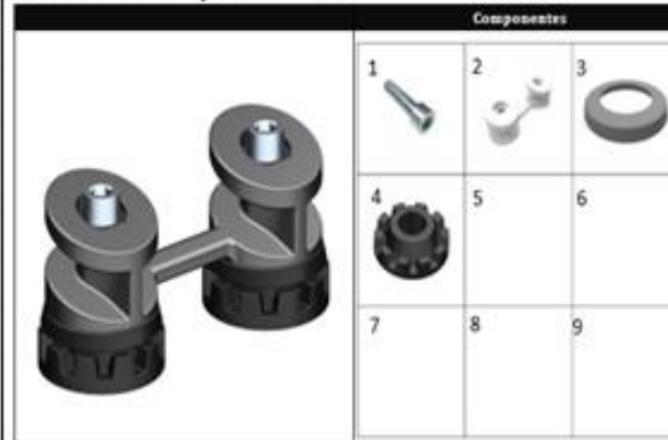
FIGURA 12: SOPORTE TANQUE DE COMBUSTIBLE
