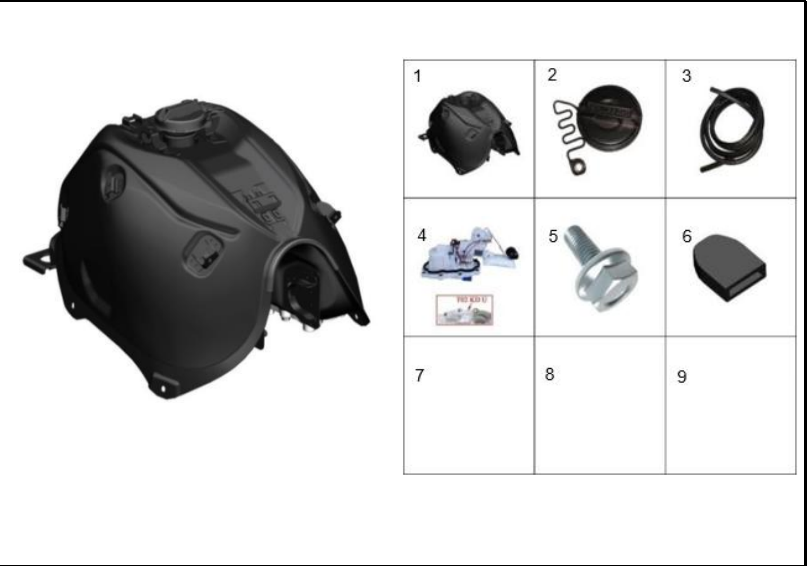
FIGURA 11: TANQUE DE COMBUSTIBLE
