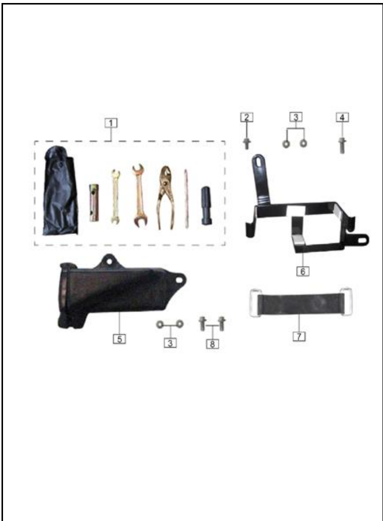
FIGURA N° 14: SOPORTE BATERIA-CAJA HERRAMIENTAS
