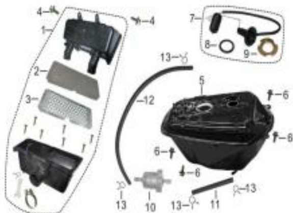
FIGURA N° 19 CAJA FILTRO AIRE - TANQUE GASOLINA
