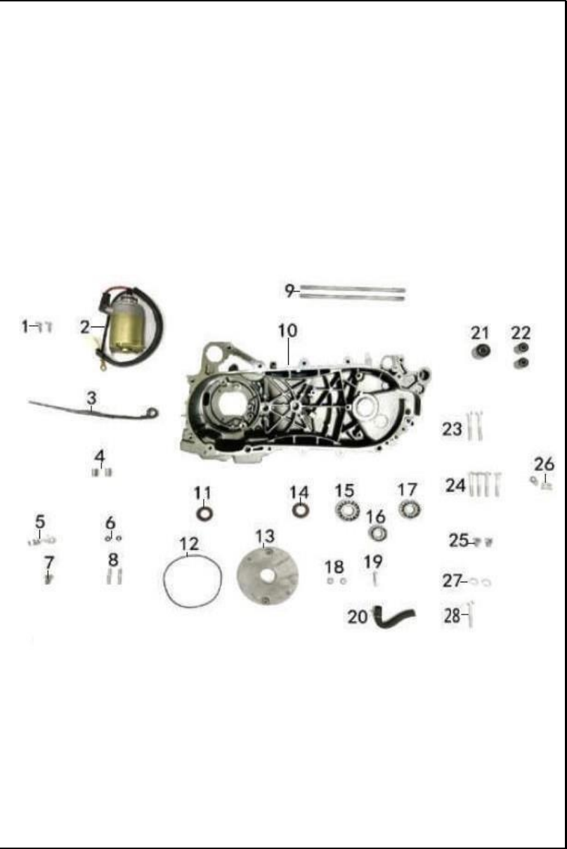
FIGURA N° 5: CARCASA MOTOR IZQUIERDA - MOTOR DE ARRANQUE (1/2)
