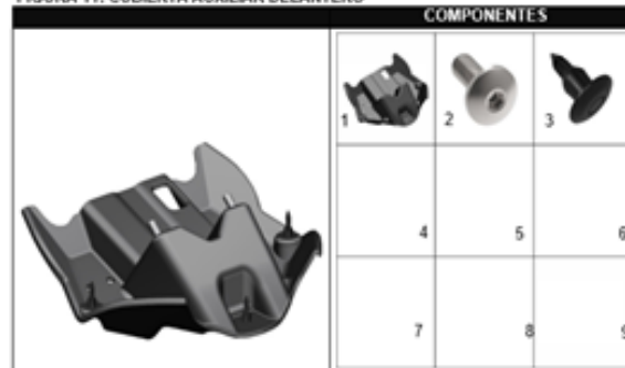
FIGURA 11: CUBIERTA AUXILIAR DELANTERO
