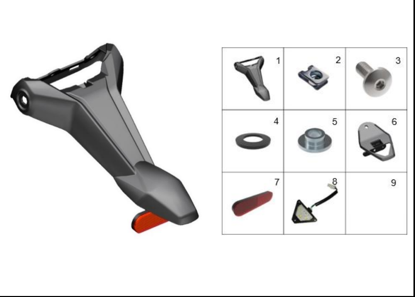
FIGURA 28: CUBIERTA GUARDABARRO TRASERO
