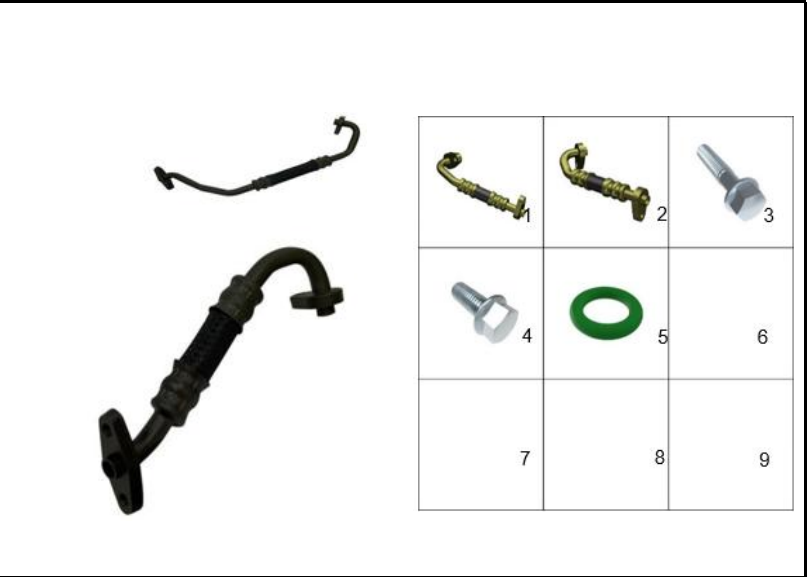
FIGURA 95: TUBO ENTRADA – SALIDA DE ACEITE
