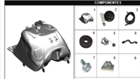
FIGURA 15: TANQUE DE COMBUSTIBLE
