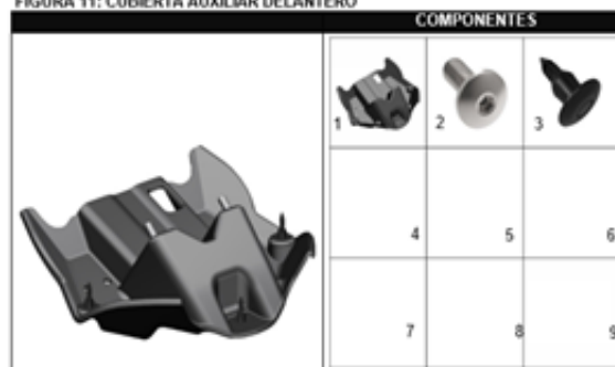
FIGURA 11: CUBIERTA AUXILIAR DELANTERO
