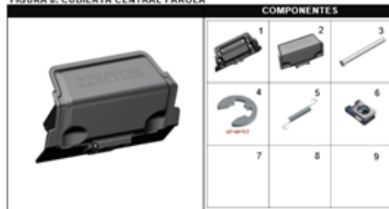
FIGURA 8: CUBIERTA CENTRAL FAROLA
