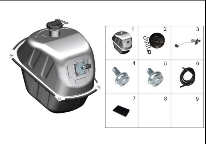
FIGURA 38: TANQUE DE COMBUSTIBLE
