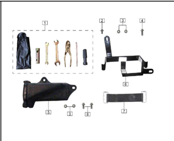
FIG. Nº 14 SOPORTE BATERIA-CAJA HERRAMIENTAS
