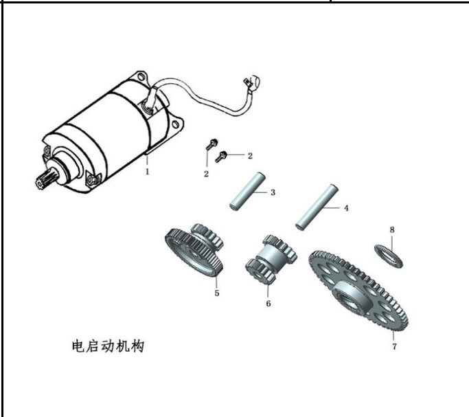
FIG. Nº 11 MOTOR DE ARRANQUE
