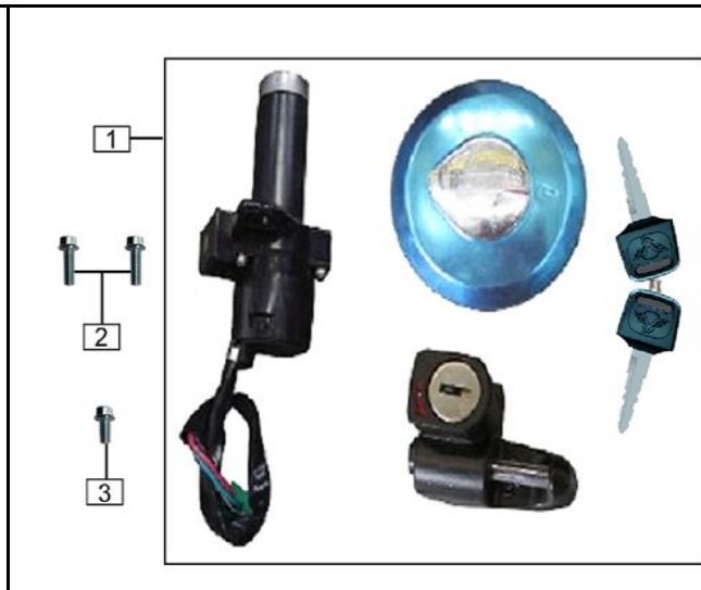
FIG. Nº 14: SWICHE DE ENCENDIDO
