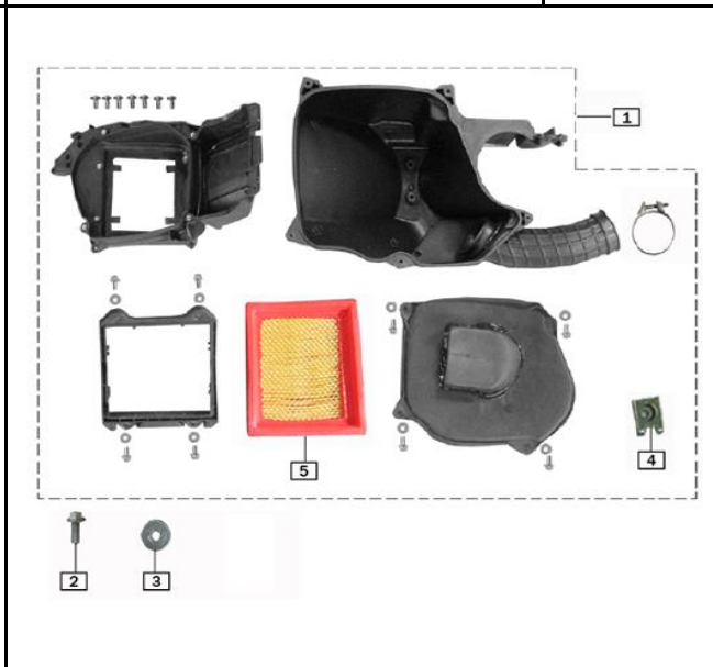
FIG. Nº 23: CAJA FILTRO AIRE
