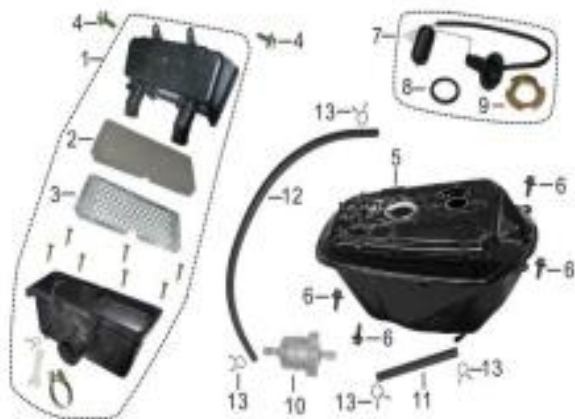
FIGURA N° 19 CAJA FILTRO AIRE - TANQUE GASOLINA
