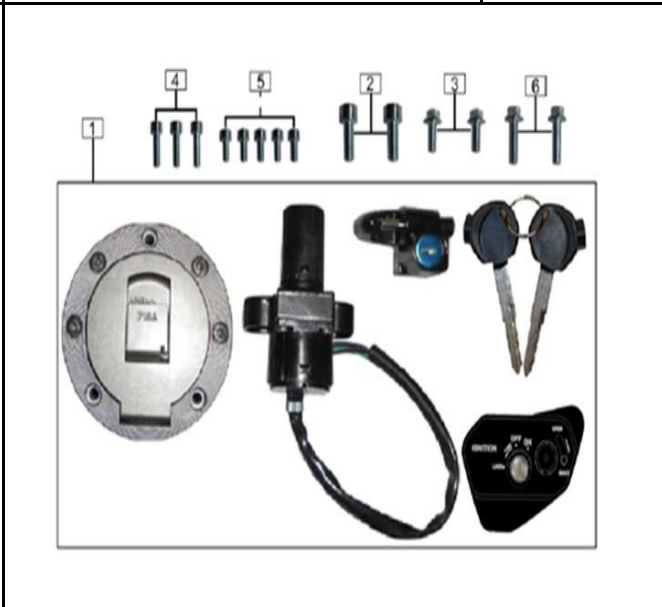
FIG. Nº 35 SWICHE DE ENCENDIDO
