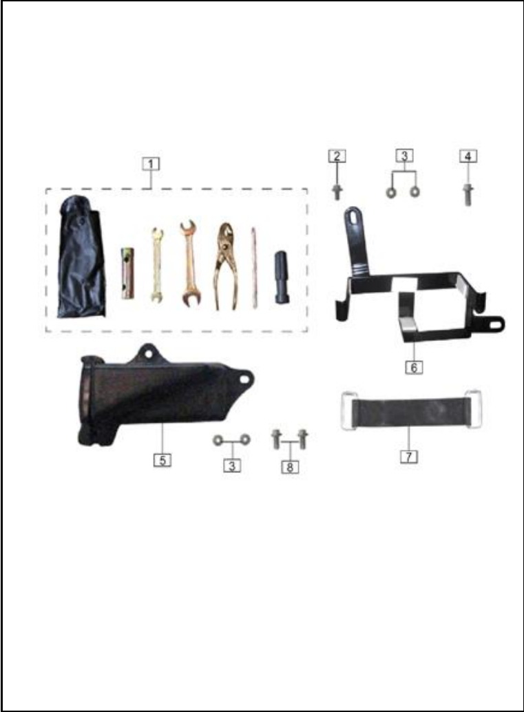
FIGURA N° 14: SOPORTE BATERIA-CAJA HERRAMIENTAS
