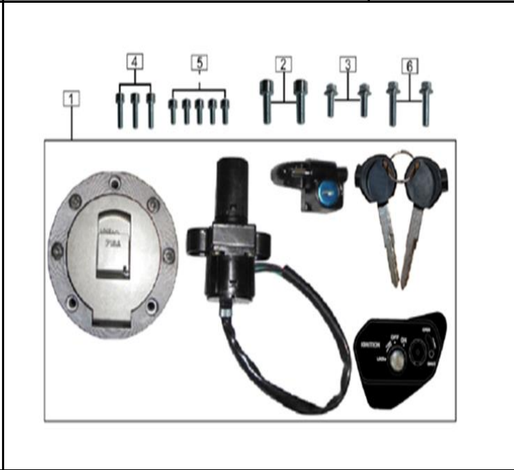
FIG. Nº 35 SWICHE DE ENCENDIDO
