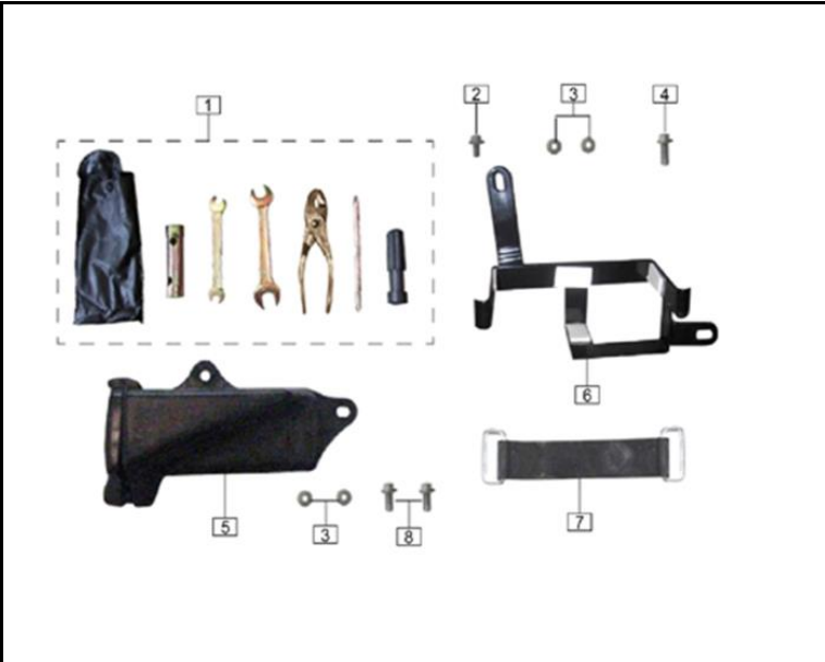
FIG. Nº 14 SOPORTE BATERIA-CAJA HERRAMIENTAS
