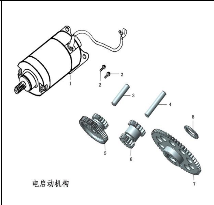
FIG. Nº 11 MOTOR DE ARRANQUE PAG. Nº 14
