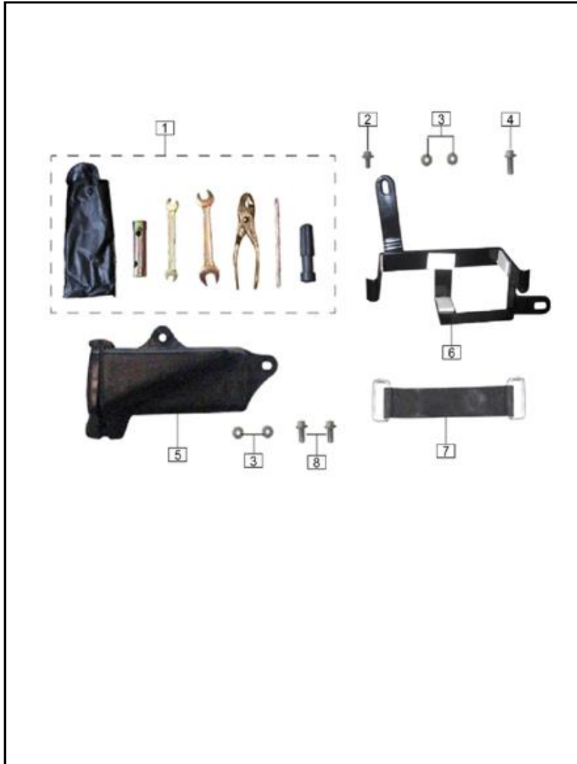
FIGURA N° 14: SOPORTE BATERIA-CAJA HERRAMIENTAS
