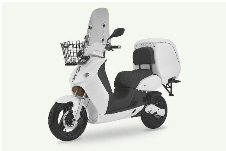
Gracias a su motor con una potencia máxima de 5,36 HP y su batería de 72V/40Ah, muy superiores a otros vehículos eléctricos de dos ruedas, la Stärker E-Cargo tiene la capacidad de llevar una carga máxima de 350 Kg. Los interesados pueden encontrar esta motocicleta en los puntos de venta autorizados Stärker a un precio sugerido al público de **\$10.990.000**.
