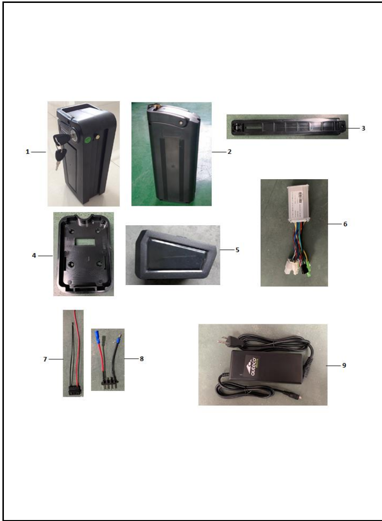
FIGURA N° 4: BATERIA - CONTROLADOR - CARGADOR
