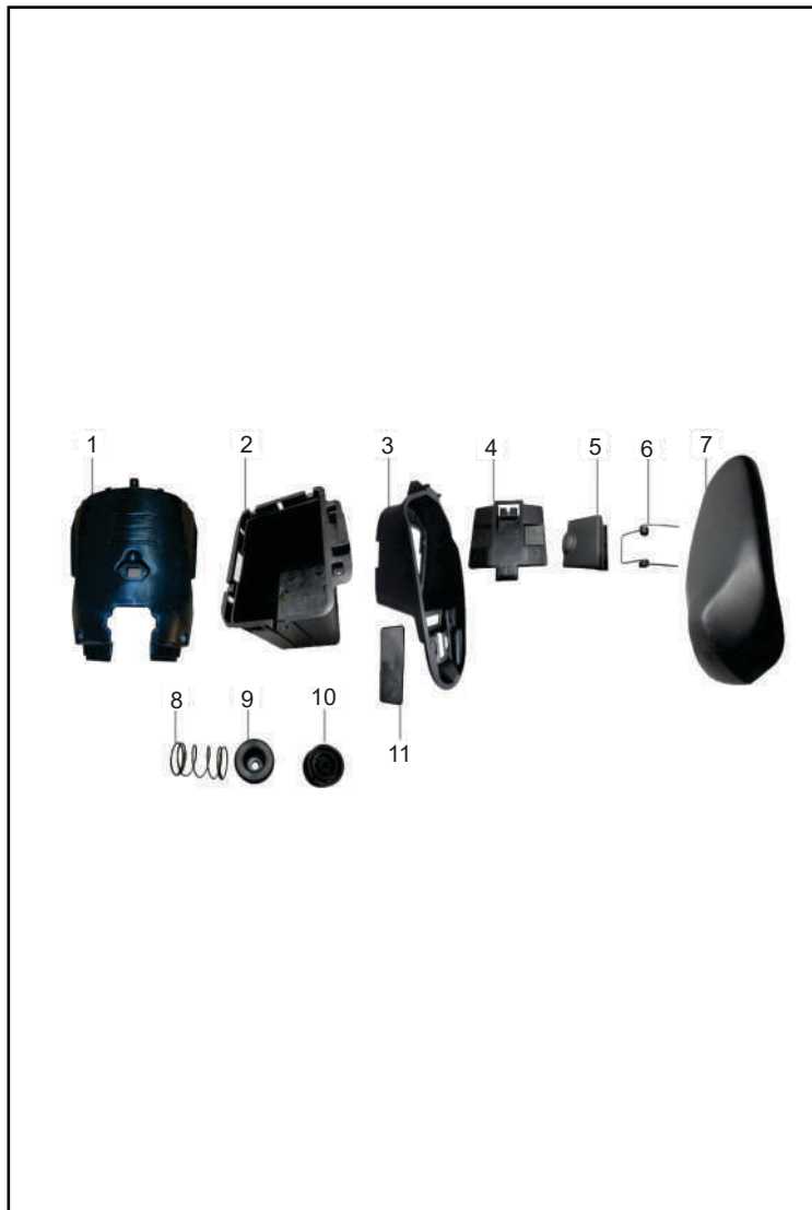
FIGURA N° 6: CAJA GUANTERA - CAJA BATERÍA
